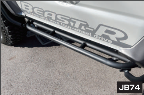
クラッシュTガード スチール製 ¥86,900 パイプフレームで構成したサイドステップです。
