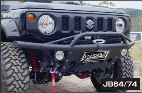
クラッシュ typeTM フロント用純正フォグランブ 取付ステー 左右セット スチール製 ¥16,500 取付の際は穴あけ加工が必要です
