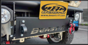
クラッシュバンパーブラケット ¥6,600 JB64にクラッシュフロントバンパー装着する際に 必要なブラケットです。純正フレームの先端をカットし、 ブラケットを溶接で取り付けます。溶接加工が必要。
