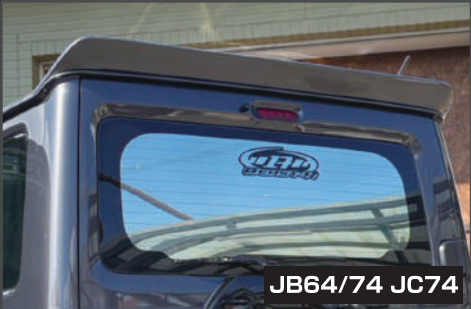
クラッシュ リアスポイラー FRP製未塗装 ¥34,100 ダックテールスポイラー。 取付は両面テープとビスで固定します。
