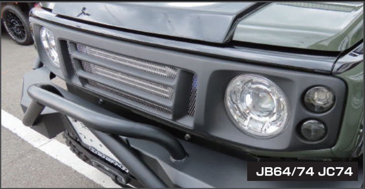
レトロ フロントグリル FRP製未塗装 ¥44,000 JA22ジムニーを感じさせるデザインのFRP製フロントグリルです。 固定方法は、車体に元々ある穴を利用しての、裏からビスを使つての固定となります。 ウィンカーの下側の窪みは、アレンジ自在。メッシュ付属。
