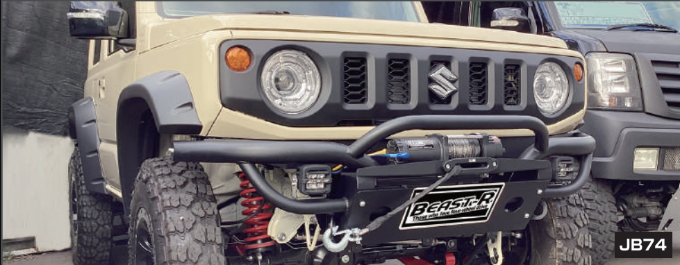
クラッシュ type Z フロントバンパーセット スチール製 ¥92,400 本体、アンダーガード、アンダーガード、IPF等のフォグランブ取付可能
