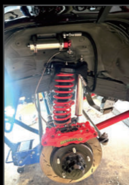
クラッシュ 4ポット キャリパー ビッグローター キット JB64/JB74/JC74 ¥275,000(JSU169) ビーストアールオリジナルブレーキシステム。当社レースカーで過激なテストを繰り返したハイパフォーマンスブレーキシステムです。キャリパー部分のロゴは白/赤と黒/黄の2色より選択可能。
