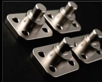
偏芯キングピン ¥41,800 (JSU157) 純正キングピンを撤去し、上下に取り付けることで2度ネガティブキャンバーを実現しました。コーナリング中のフロントグリップを大きく向上させシムニーで異次元のコーナリングを楽しめます。
