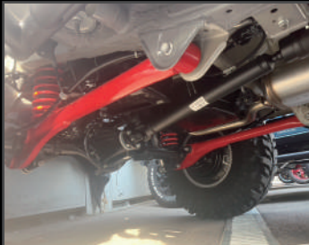
リアトレーリングアーム ¥60,720 (JSU125) 2インチ用～5インチ用まで設定あり
