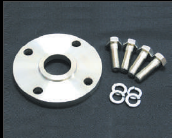
プロペラシャフトスパーサー ¥9,900 (JSU156) リバウンド時のプロペラシャフトの抜けを防ぎます。3インチ以上のリフトアップは必須
