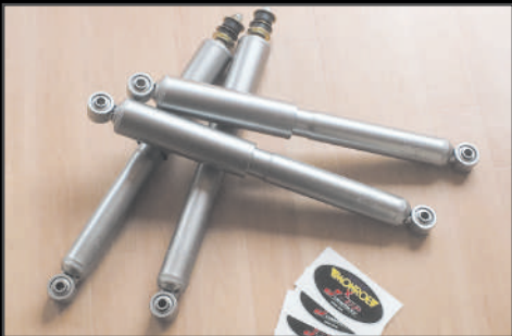
モンロー・ロードマチック 2インチ/3インチ用 ¥60,060 (JSU127) MONROE社製。基本性能と低価格を両立させたショックアブソーバー。フロント・リア共に純正ショックに対し、伸び側の減衰を多少強めているが、縮み側は純正よりも、ふたまわり大きいピストンバルブ(30φ)を採用する事により腰砕けせず、しっかりした乗り味を実現しています。
