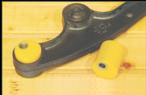
スペシャルキャスト 2個 ¥11,000 (JSU138) 偏心量大きいキャスト補正プッシュです。純正アームで2インチ以上リフトアップする際は偏心プッシュと交換をしキャスト角の補正をしましょう。
