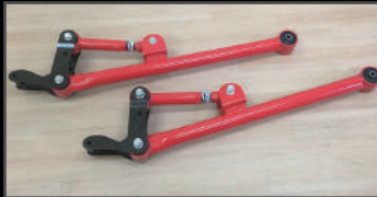
リアMOリンクキット ¥148,500 (JSU126) ホーシング側にブラケットを装着し、プッシュを片側4カ所にする事で、ストロークや擦れは純正の比ではないくらい良く動く足に変身します。アッパーアームが調整式になっているため、コイルの弓なりも補正でき、乗り心地も良くなります。5リンクでは気になるロールやワインドアップも、このMOリンクでは気にならない程度です。
