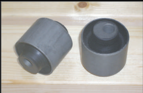
キャストープッシュ 2個 ¥8,800 (JSU137) 純正アームのプッシュと交換することで角度補正を行います。コイルの弓なりを改善します。
