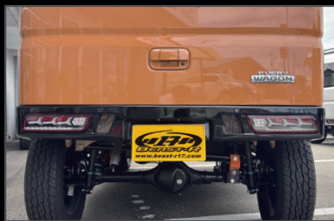
SSリアバンパー DA17W/V FRP製未塗装 ¥30,800 アルミメッシュ付き。別途専用テールランプが必要と なります。コーナーセンサー装着車は、 バンパーの穴あけ加工が必要です。
