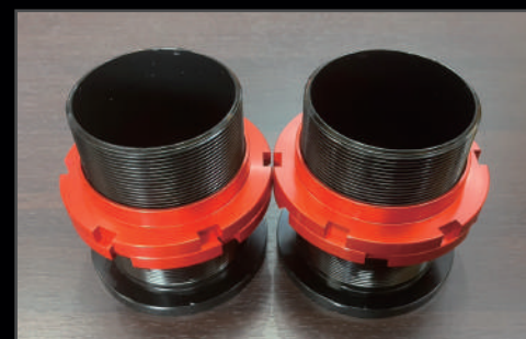
リアスプリングアジャスター ¥33,000 純正スプリングからビーストアール5.5インチコイル まで使用可能なアジャスターです。 ネジ式調整式で、約20ミリから55ミリほどの リフトアップが可能!
