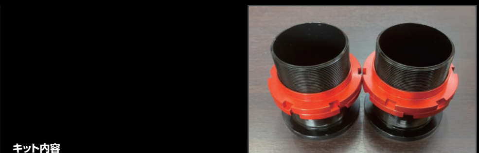
リアスプリングアジャスター ¥33,000 (ESU055) 純正スプリングからピストアール5.5インチコイル まで使用可能なアジャスターです。 ネジ式調整式で、約20ミリから55ミリほどの リフトアップが可能。
