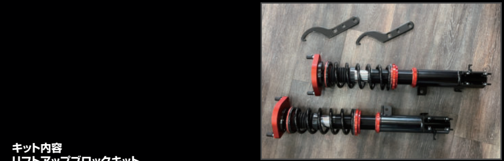
フロント全調式車高調整キット ¥165,000 (ESU053) 直巻きスプリング使用でバネレート3k~を自由に 選択できます。2インチアップから5インチアップ まで対応。リフトアップブロックと併用で更に リフトアップが可能になります。
