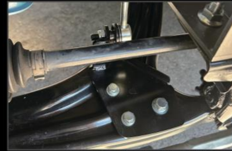
フロントスタビライザー移設キット DA17W/V ¥21,780 (ESU060) 純正はストラットにスタビリンクが付いております。ロアアームに移設することでダイレクトにスタビライザーが効き、ふらつきを押さえます。
