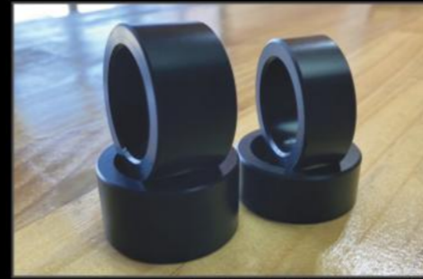
ステアリングストッパー DA17W/V ¥11,000 (ESU066) タイヤを大径化するとタイヤハウス内側が干渉します。ステアリングストッパーで切れ角を制限することで、干渉を防ぎます。
